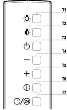
T1 : Aydınlatma sistemini açar-kapatır.
